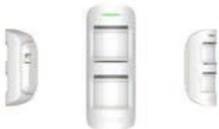
Zuverlässige und sichere Erkennung menschlicher Bewegungen im Außenbereich durch 2 Infrarotsensoren. Alarmauslösung nur wenn beide Temperatursensoren identische Bewegungssignale erkennen, dabei werden Haustiere mit einer Größe von bis zu 80 cm ignoriert. Empfindlichkeit in 3 Stufen einstellbar, Erfassungswinkel horizontal 90°, Erfassungsbereich bis 15 m. Signalstörungserkennung, Manipulationsalarm.
